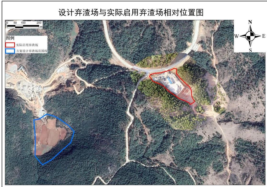
图 3-1 设计弃渣场与实际布置弃渣场位置关系图
