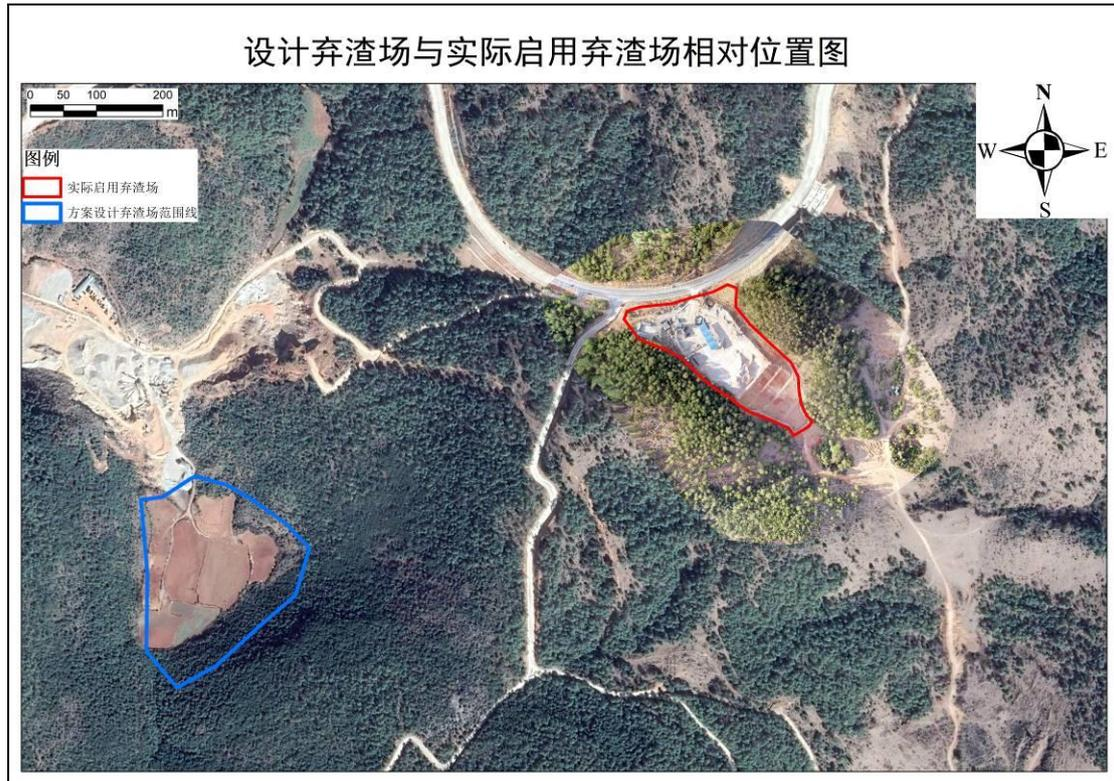
图 1-22 设计弃渣场与实际布置弃渣场位置关系图
