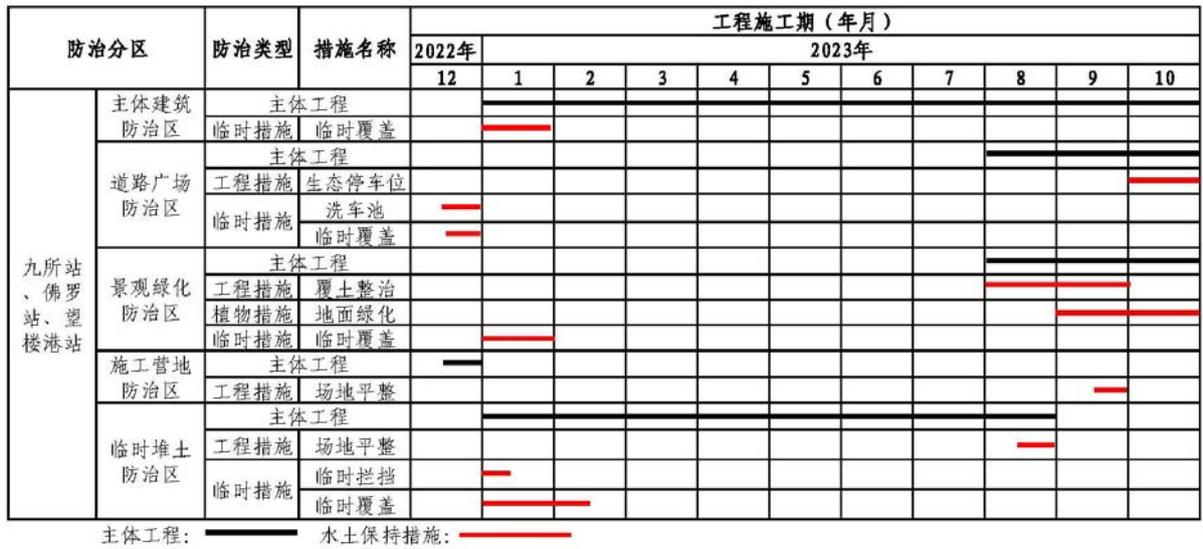
图 4-3 水土保持措施实施进度图 (九所站、佛罗站、望楼港站)
