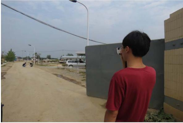
测距仪测量道路长度
