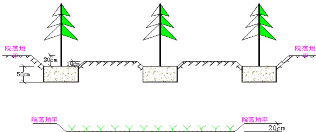
图 5-7 树池及低位绿地结构设计图
